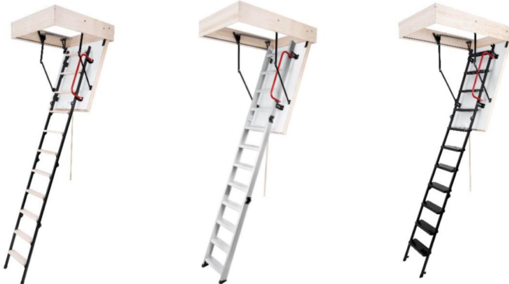
Все модели, входящие в семейство POLAR, имеют в своей конструкции специально утолщенную теплоизоляционную крышку толщиной 86 мм, внутри которой уложены пенополистирольные плиты толщиной 80 мм. Такая конструкция крышки обеспечивает лестницам этого семейства наилучший показатель теплосбережения – коэффициент теплопередачи  $U = 0,36 \text{ W/m}^2\text{K}$ . Тем самым экономятся затраты на оплату энергоносителей.
