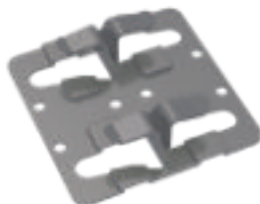
Крепежный кляммер рядовой ККР-70x10, t=1,0 мм
