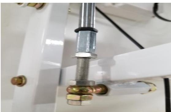
4. Концевой выключатель сверху не подлежит регулировке, концевой выключатель на двери был отрегулирован при тестировании лестницы на заводе в зависимости от высоты, предоставленной клиентом. Но иногда между реальной высотой и высотой, предоставленной клиентом, может быть большая разница, поэтому в этом случае клиенту необходимо отрегулировать концевой выключатель в нижней части люка.
